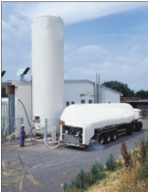
Obr. 7 Přeprava kyslíku v kryogenní cisterně
